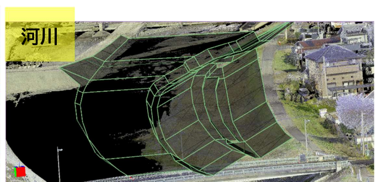
三次元設計: ICT施工 起工測量・3D 設計データ
